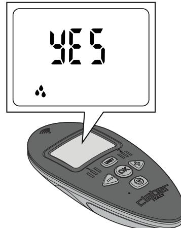
**IT PROGRAMMAZIONE DELL'IRRIGAZIONE - Rain sensor RF.** Dalla pagina RAIN SENSOR premere il tasto OK, si accede alla attivazione/disattivazione del Rain Sensor RF (Sensore di Pioggia in radio frequenza). Con la pressione della freccia destra si cambia lo stato da "NO" (sensore disattivato) a "YES" (sensore attivato) e viceversa. Confermare premendo OK. Il riconoscimento tra i dispositivi avviene nell'arco di circa 5-10 minuti.
